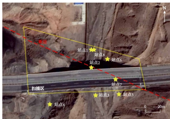
图 6 工程场地与断裂交汇处扫描站点位置 黄星代表站点位置, 红色虚线为推测断层位置; 卫星图来自谷歌地图 2020 Maxar Technologies
