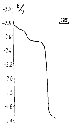
图2 镍电极在750℃, LaCl 3 (7.2wt%)-NaCl-KCl熔体中电沉积后的电位-时间曲线(电沉积条件: I = 50\text{mA} , t = 50\text{s} )
