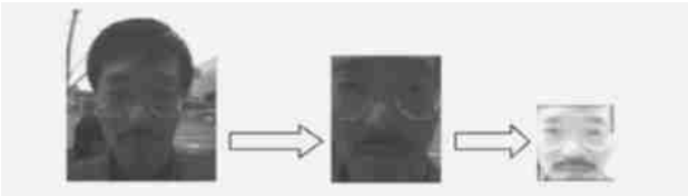
(a) 原始图像 (b) 人脸定位 (c) 直方图匹配 图 1 对人脸进行直方图匹配前后对比
