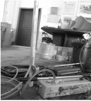
图 5 测量混凝土砌块体积改变
