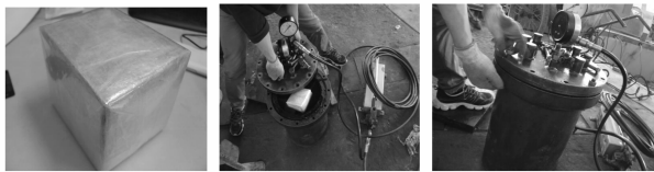
图 3 加气混凝土围压实验
