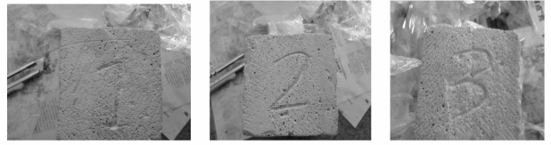
图 4 加气混凝土试块实验结束后的形态
