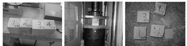
图 1 加气混凝土单轴抗压强度实验
