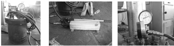
图 2 围压试验压力罐和手动油泵
