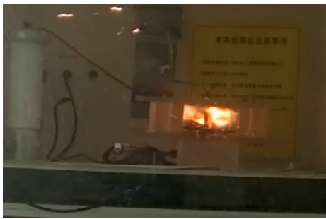
图6 冲击电流作用下的可燃物着火现象
